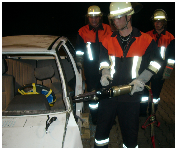
Technische Hilfeleistung an einem verunfallten PKW
